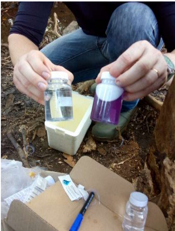
Figura 07e 08: utilização do kit COLItest para identificação de presença ou ausência de coliformes.
