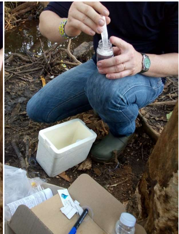
Figura 07e 08: utilização do kit COLItest para identificação de presença ou ausência de coliformes.
